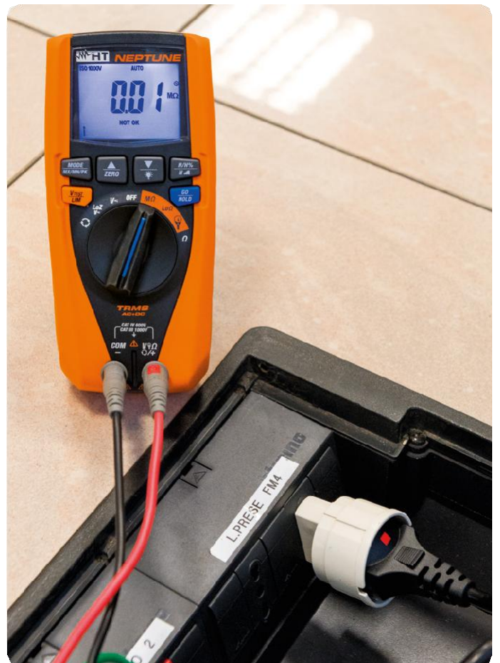
Měření izolačního odporu (volitelný adaptér Schuko C2065).
