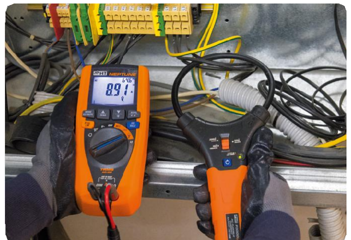
Měření proudu pomocí flexibilního převodníku F3000U.
