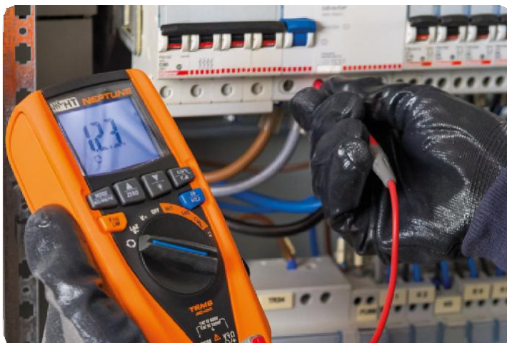
Měření sledu fází jedním vodičem.
